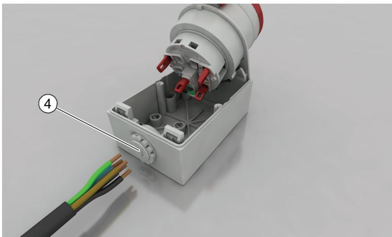
7. В исходном состоянии клеммы открыты. Завести зачищенные концы проводников в отверстие рядом со скользящим контактом (6) и отжать скользящий контакт (5) в сторону, в направлении стрелки. Скользящий контакт защелкивается и фиксирует отдельный проводник. Следите за тем, чтобы зажималась только зачищенная часть отдельного проводника (без изоляции). Обращайте внимание на маркировку клемм и убедитесь, что отдельные проводники правильно расположены относительно клемм.
