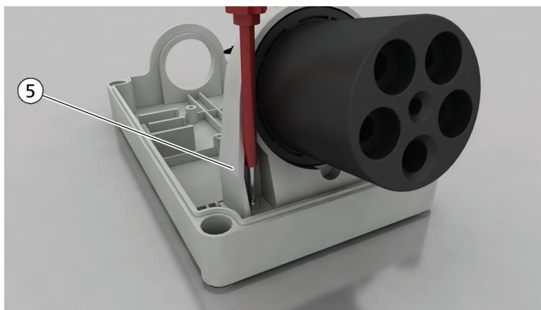
8. В исходном состоянии клеммы открыты. Завести зачищенные концы проводников в отверстие и затянуть винты (6) с минимальным моментом затяжки (исполнение на 63 A, контактные винты M5: минимум 2,0 Нм; исполнение на 125 A, контактные винты M10: минимум 4,0 Нм). Следите за тем, чтобы зажималась только зачищенная часть отдельного проводника (без изоляции). Обращайте внимание на маркировку клемм и убедитесь, что отдельные проводники правильно расположены относительно клемм.
