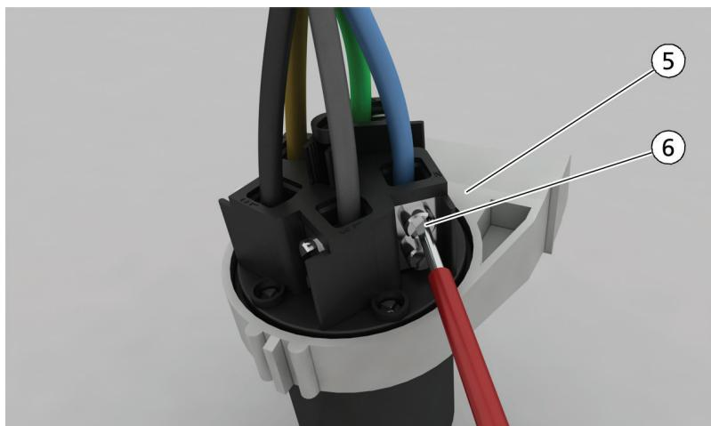
9. Проверьте плотность посадки, слегка потянув за отдельный проводник. Если проводник болтается, откройте клемму и повторно выполните предыдущее действие.
