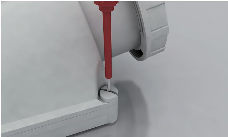
3. Открутить два крепежных винта 5 × 20 мм и снять держатель контактов (5).
