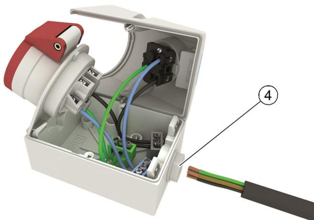
8. В исходном состоянии клеммы открыты. Завести каждый отдельный проводник в отверстие (6) и затянуть винт (5) с усилием не менее 0,8 Нм. Следите за тем, чтобы зажималась только зачищенная часть отдельного проводника (без изоляции). Обращайте внимание
