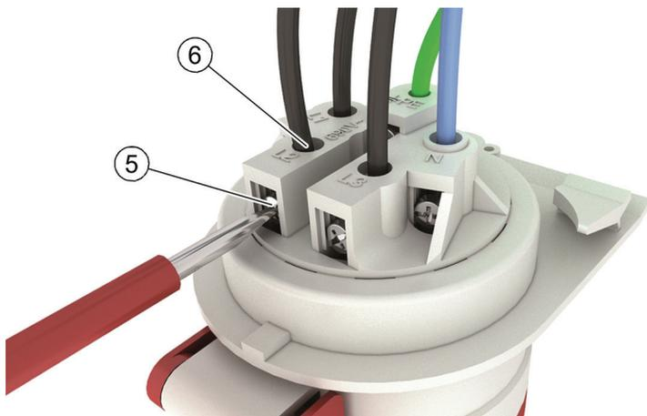
9. Проверьте плотность посадки, слегка потянув за отдельный проводник. Если проводник болтается, откройте клемму и повторно выполните предыдущее действие.
