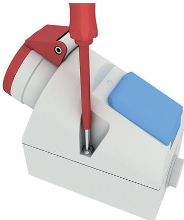
5. Для вариантов без проводки: установите необходимые соединения внутри настенной розетки в соответствии с тремя допускаемыми возможностями подключения и проверьте их. Затяните винты на соединительных клеммах (7) с моментом затяжки не менее 1,2 Нм.
