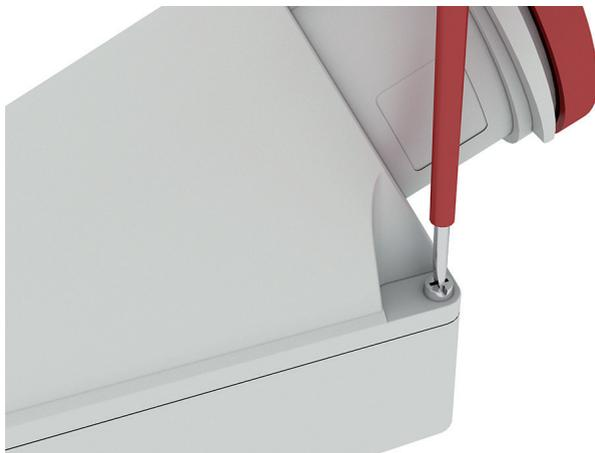
5. Нижнюю часть корпуса закрепить на стене при помощи пригодного для этого крепежного материала.
