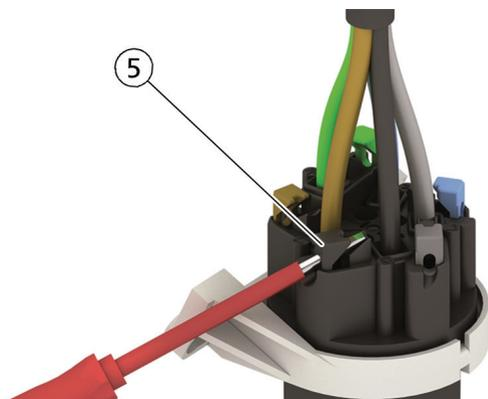
5. Настенные розетки и штекеры: Вытащить провод из корпуса и из гермоввода (4).
