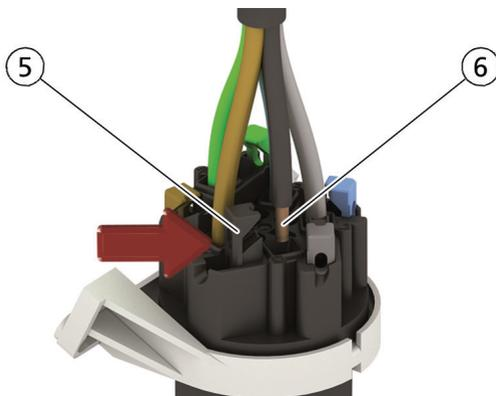
9. Проверьте плотность посадки, слегка потянув за отдельный проводник. Если проводник болтается, откройте клемму и повторно выполните предыдущее действие.
