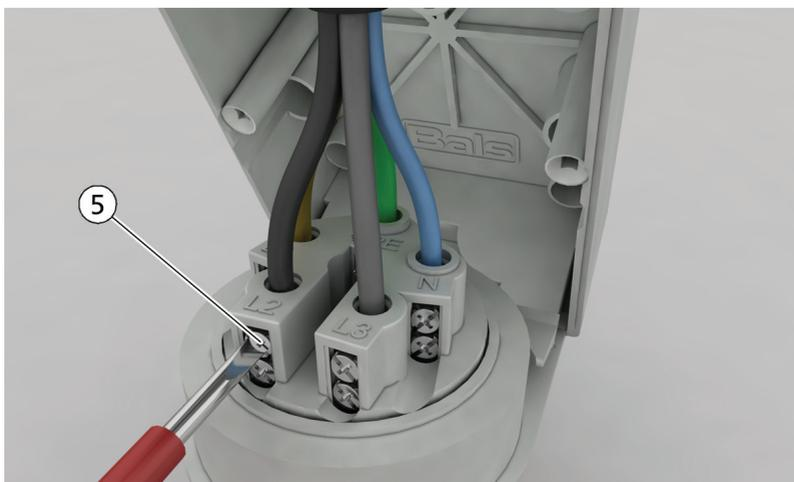
4. Extraiga el cable fuera de la carcasa, y, dado el caso, también del racor de cable (4) (tomos de corriente o clavijas para el montaje en pared).
