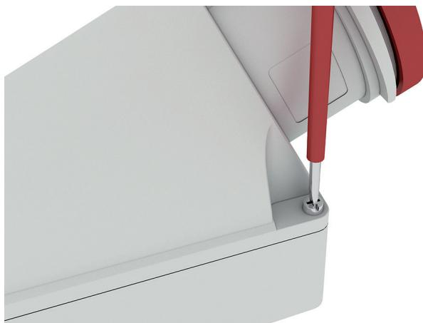
3. Afloje el racor de cable y el portacontactos de la parte inferior de la carcasa.
