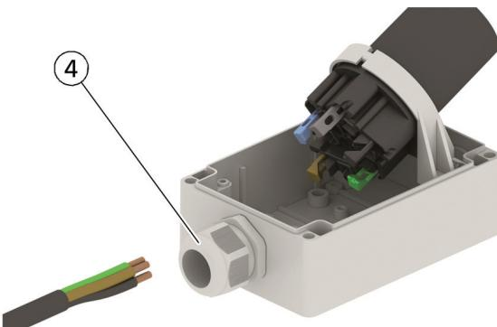
6. Vuelva a fijar el portacontactos en la parte inferior de la carcasa.
