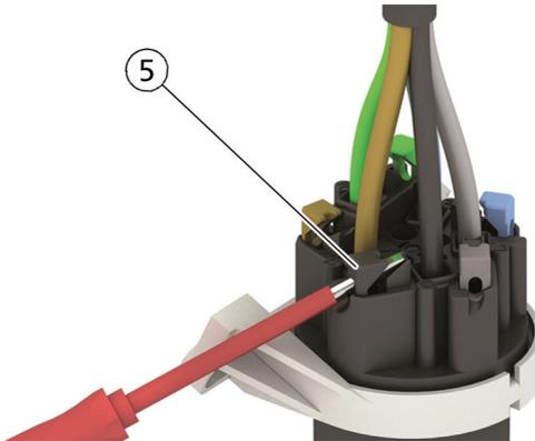
5. Bei Wandsteckdosen- und -steckern: Ziehen Sie die Leitung aus dem Gehäuse und aus der Kabelverschraubung (4).
