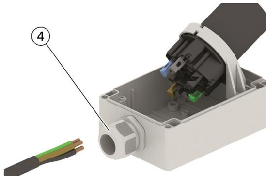
6. Befestigen Sie den Kontaktträger wieder am Gehäuseunterteil.
