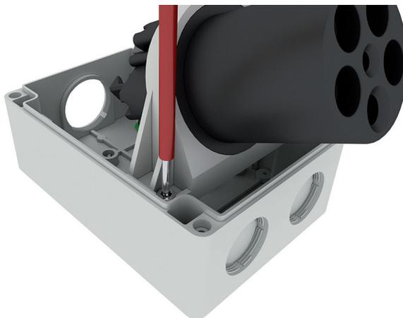
7. Schieben Sie die Leitung durch die Kabelverschraubung (4) in das Gehäuse.
